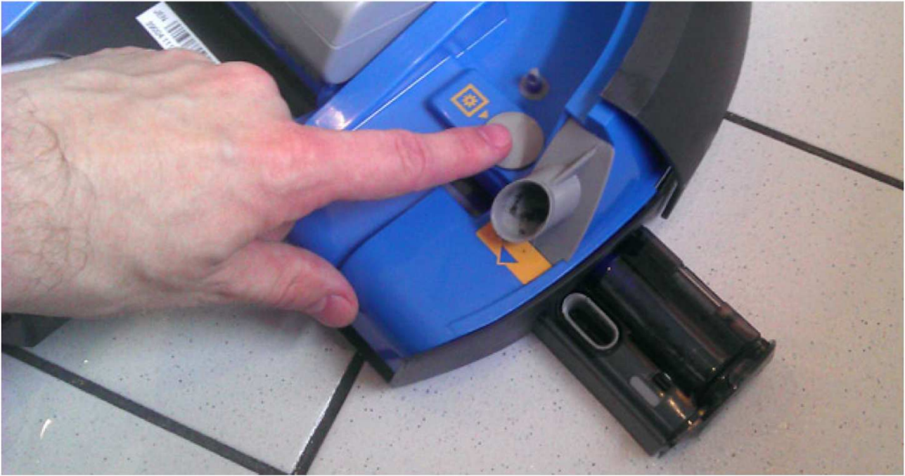
Ce bouton libère le bloc de la brosse rotative, qui fait office d'aspirateur d'appoint.
