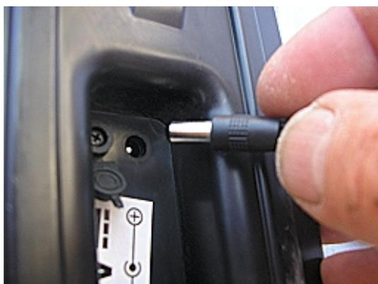
Pour tester l'adaptateur avant de l'utiliser, il faut le brancher sur une prise AC de 230V sans le connecter à la patinette.
