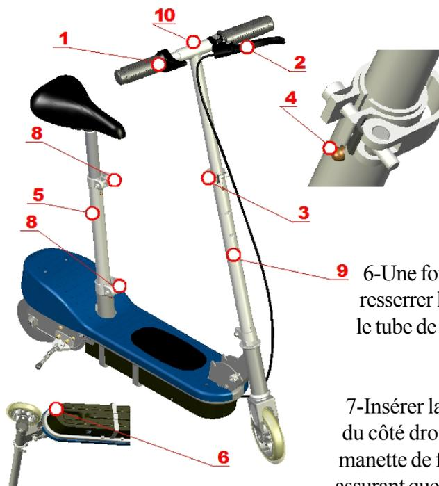
5-Desserrer le blocage rapide (3) du tube allonge (9) ; tirer doucement le tube en T vers le haut jusqu'à ce que la bille de système de blocage s'engage dans un des trous du tube vertical à la hauteur souhaitée.
