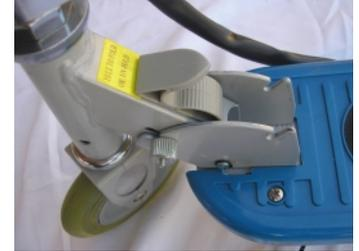
4-Ré-engager le boulon de serrage dans l'encoche supérieure et resserrer le blocage rapide pour verrouiller la colonne de direction en position correcte.
