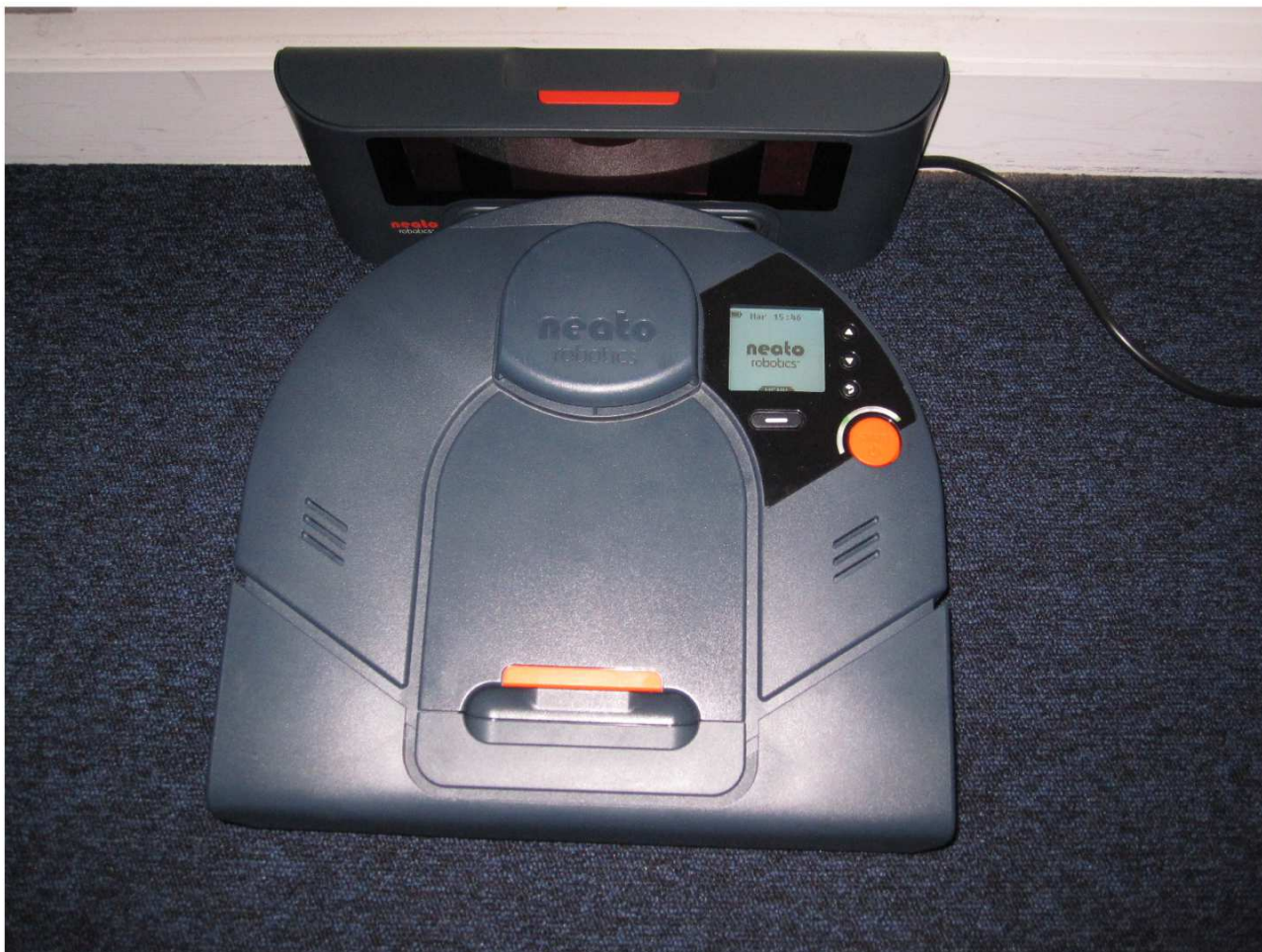
Première approche : une forme de D peu commune, peu de boutons, un écran rétro-éclairé et une base peu encombrante.
