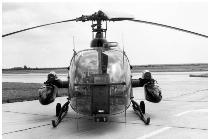
Gazelle SA 341 F n°1255 Aérospatiale avec panier lance-roquettes Mitra (photo CEV)
