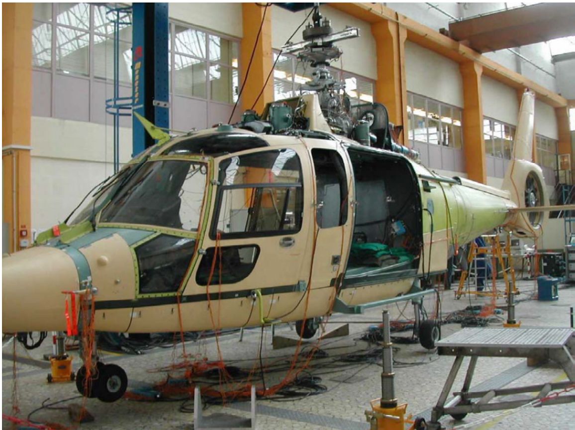
Figure 10 : essai vibratoire au sol de l'EC 155
