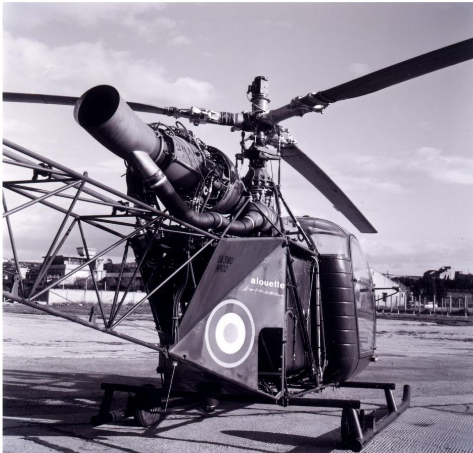
Alouette II Astazou SA 3180 n°02 avec moyeu MIR de Bolkow
