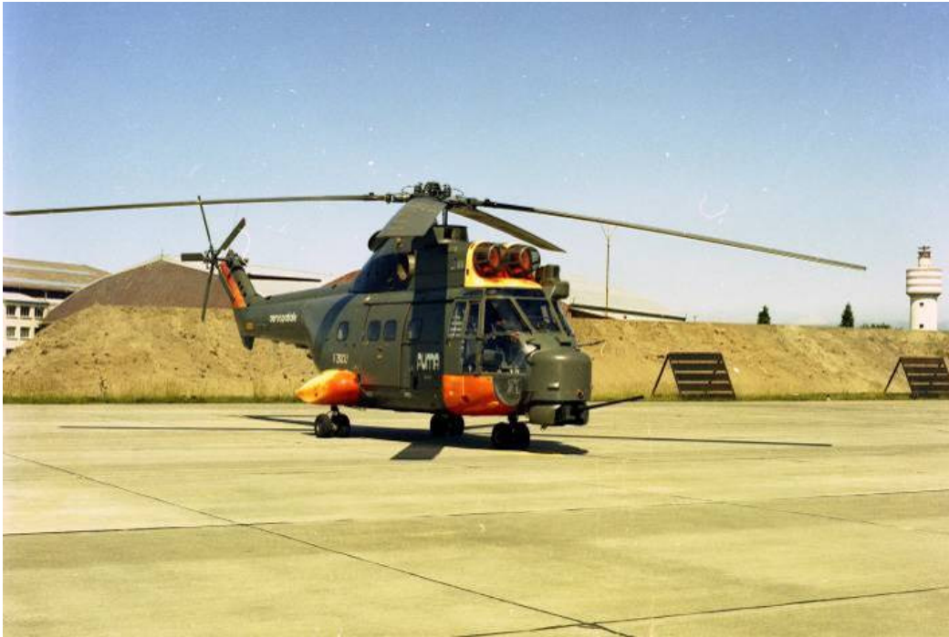
Puma 04 HECTOR : appareil de servitude pour canon de 30 mm en tourelle, au profit du Tigre (photo CEV)
