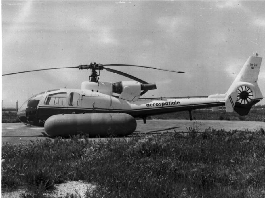
SA 341 01 avec flottabilité de secours gonflée (photo CEV)
