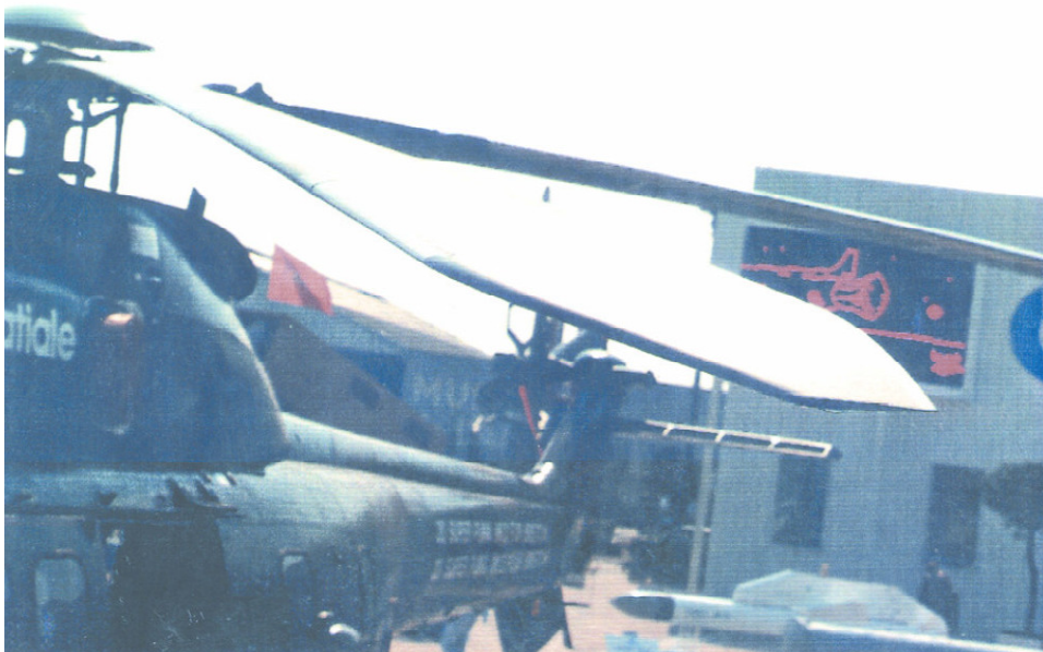
Figure 2 : extrémité parabolique avec mise en dièdre testée sur Puma
