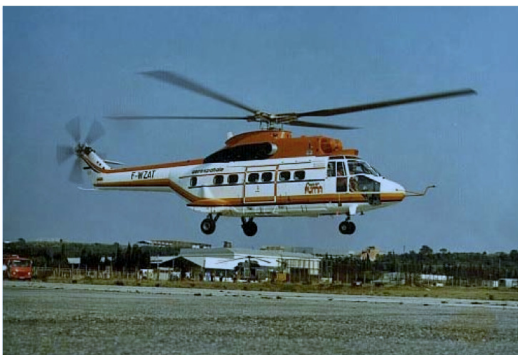
Le SA 331 au cours de son premier vol. L'appareil a été profondément modifié et le nez rallongé. Remarquer la tête rotor, le train et la poutre de queue. Copyright EC.
