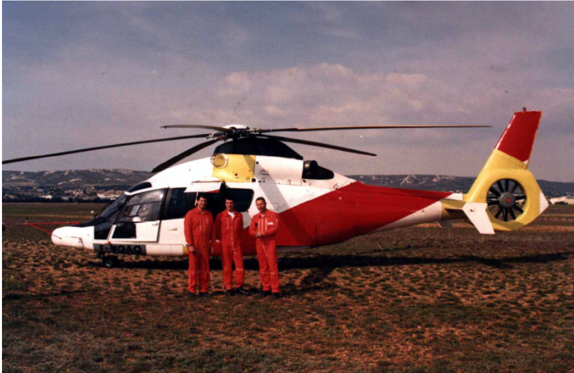
Figure 9 : démonstrateur Eurocopter DTV4 d'hélicoptère silencieux
