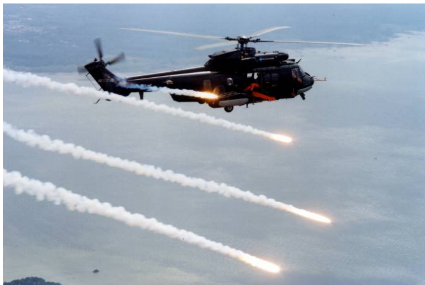
Super Puma AS 532 UL équipé de lance-leurres (photo CEV)
