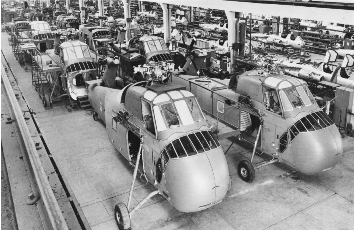
Chaîne de montage S-58 à Marignane avec, à l'arrière plan, la chaîne Fouga
