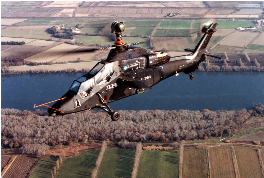
Prototype n°1 destiné aux essais « véhicule » (performances, qualités de vol,...) ici en configuration HAC (avec une maquette de viseur de mât)
