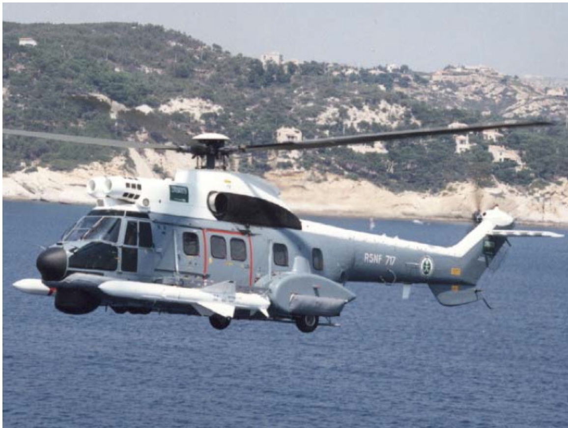
L'AS 332 F1 équipé de ses 2 missiles subsoniques Exocet.
