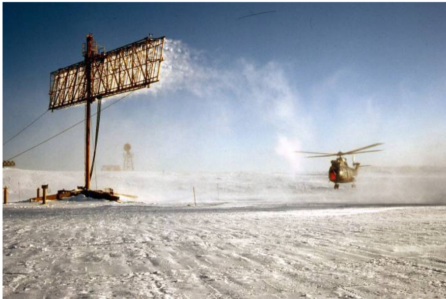
Essai de givrage devant la grille du NRC à Ottawa (photo CEV)
