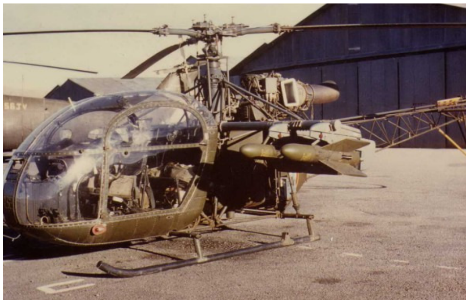
Alouette II équipée de SS 11 (photo Norbert Forget)
