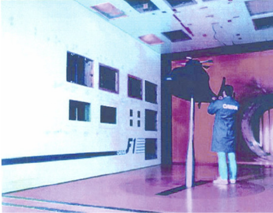
Figure 5 : maquette DGV 200 dans la soufflerie pressurisée F1 du Fauga
