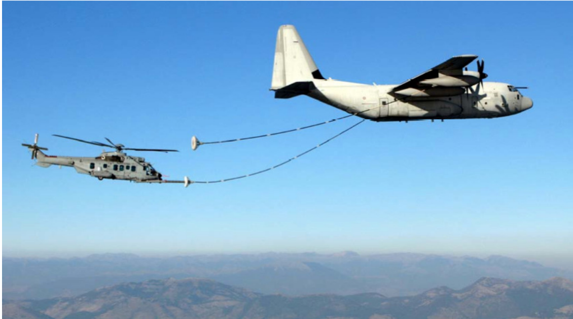
L'EC 725 AP ravitaillé à partir de l'avion de transport Hercules KC-130 J.
