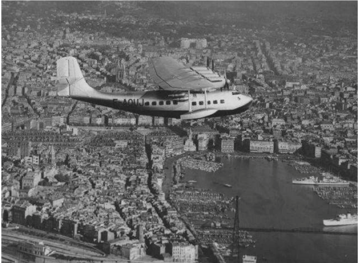
LeO HY 246 prototype sur le vieux Port à Marseille, en 1939 Quadrimoteur, 23 passagers, 1.500km d'autonomie.
