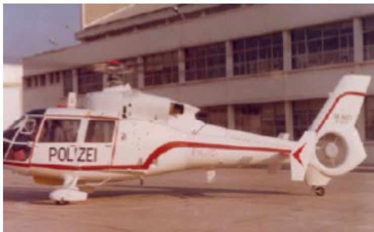
Figure 4.1 SA 365C – 1975 – C_x S = 1,4 \text{ m}^2
