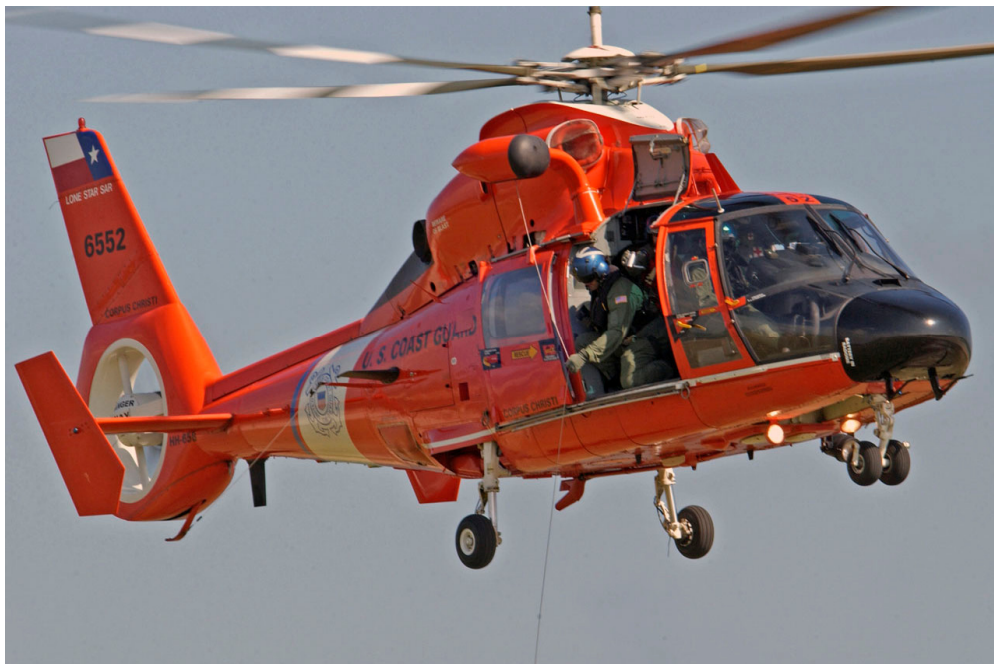
SA 366 G1 des US Coast Guards. On note le fenestron agrandi et le treuil spécifique
