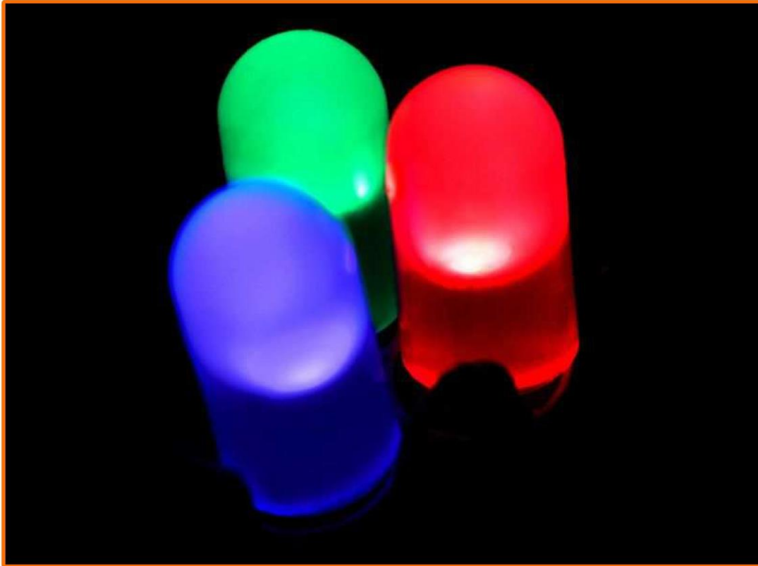
Led rouge, bleu et verte à la base de la production d'une lumière blanche. © PiccoloNamek, Wikimedia GFDL 1.2 CC (by-sa 3.0)
