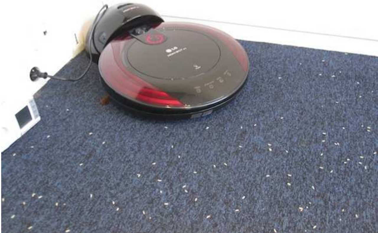
Le Hom-Bot est vraiment doué pour retrouver sa base. Son look façon grosse coccinelle aux bordures rouges est complété par un afficheur comportant des icônes rouges. L'affichage circulaire indique le niveau de charge de la batterie ; il tourne lorsque l'appareil fonctionne.
