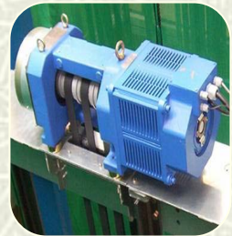
Moteur d'entraînement de la cabine
