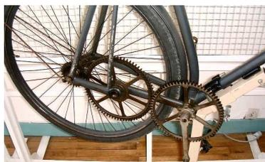
En **1897** Bien des constructeurs cherchent à supprimer la chaîne. Divers **systèmes d'engrenages** verront le jours. Ce principes techniques sera vite abandonné à cause de sa rigidité.
