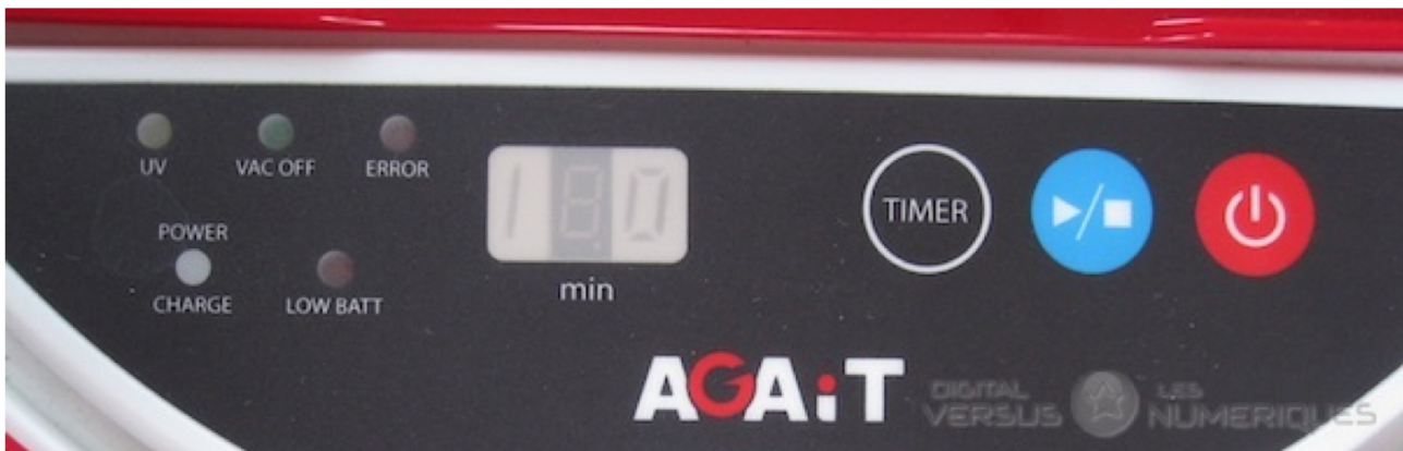
À gauche, les diodes qui s'allument pour signaler la charge, batterie faible ou les options choisies. Au milieu le cadran indique le temps et le mode. Enfin à droite le bouton pour régler la minuterie, le bleu pour démarrer/arrêter puis le rouge on/off.
